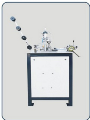
SYM-109A 全自动贴布机 Fully auto matic stick machine
